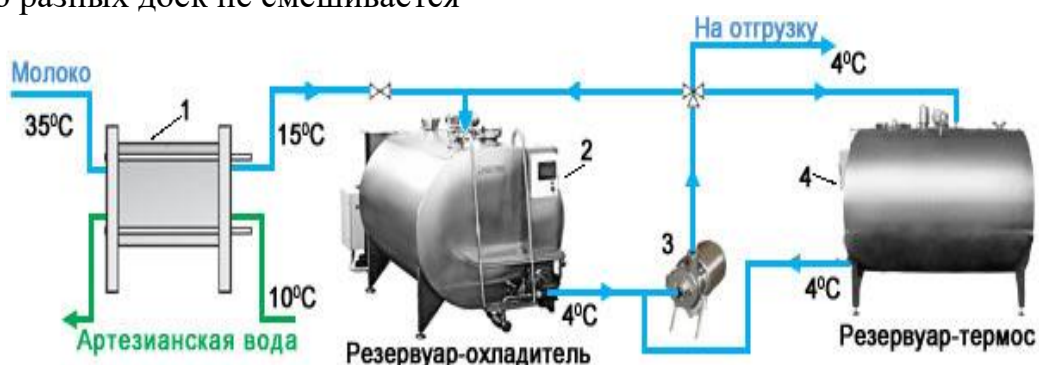
Рис.5. Комбинированное охлаждение.
