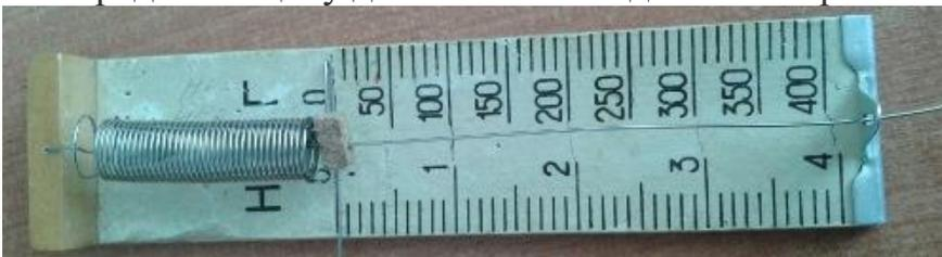
2. Определите массу бруска. Подвесьте брусок к динамометру, показания динамометра - это вес бруска. Для нахождения массы бруска разделите вес на  $g$ . Принять  $g = 10 \text{ м/с}^2$ .
